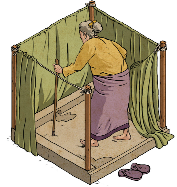
အိမ်တွင်း၌ ရေမြောင်းပါဝင်သော ကွန်ကရစ်အခင်းတစ်ခုကို တာပေါလင်စအုပ်၍ လုံခြုံသော ရေချိုးခန်းတစ်ခုအဖြစ် အသုံးပြုနိုင်သည်။ ၎င်းကို အဝတ်လျှော်ခြင်း သို့မဟုတ် ပန်းကန်ဆေးခြင်းကဲ့သို့ အခြားလုပ်ငန်းများအတွက်လည်း အသုံးပြုနိုင်ပါသည်။
