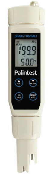
ပုံ (၁၄) - ဘက်စုံတိုင်းတာနိုင်သည့် အိတ်ဆောင် Palintest တံဆိပ် မီတာ။
