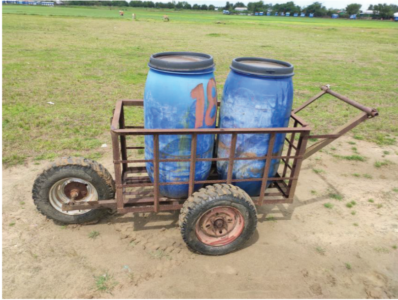
ပုံ - ၅ - “ထော်လာဂျီကားမသုံးပဲ ပုံမှန် နည်းလမ်း အတိုင်း မိလ္လာရေဆိုးထုတ်ခြင်း” နည်းလမ်းကို သုံးသည့် အခါတွင် မိလ္လာရေဆိုးများကို စည်ပိုင်းထဲသို့ထည့်ပြီး လက်တွန်းလှည်းပေါ်တွင် သယ်ကာ အနီးဆုံးတွင်ရပ်ထားပေးသည့် ထော်လာဂျီကားပေါ်သို့ သယ်သွားပေးရပါမည်။
